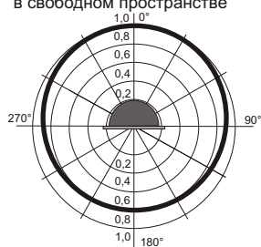
Рис.2 Схема подключения и диаграмма направленности оповещателя.
